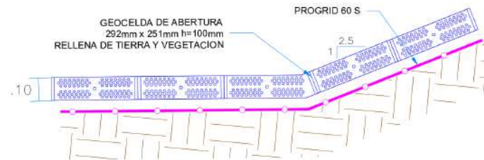
DETALLE 3: UNION TALUD Y BANQUETA ESC: 5/E
